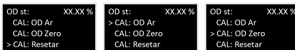
Figura 21 - Sequência de calibração do sensor de Oxigênio Dissolvido.
